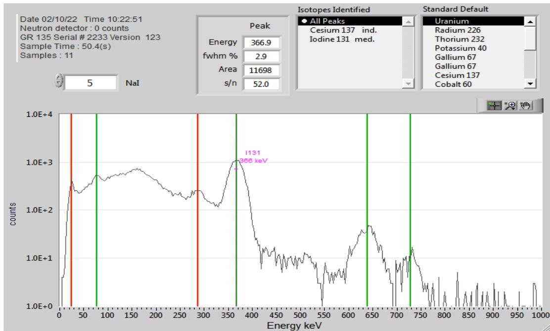
Figure 3 (عدد شکل در متن فارسی تکراری است، لطفا بررسی شود): spectrum of gamma spectrometer in 55 seconds detection for distance of 7 cm and in presence of 129.5 kilo Becquerel source in one lobe of thyroid phantom
